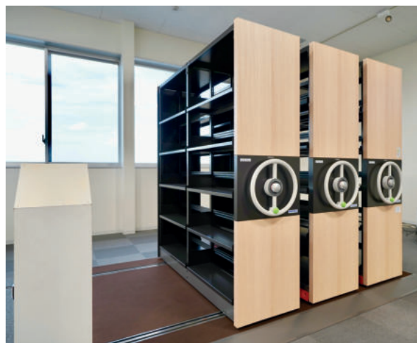
金剛が開発した「丸ハンドル式移動棚」は、ハンドル操作で棚の移動が誰でもスムーズに行える。床面には棚を移動させるためのレールを配置する。普段は棚をコンパクトに集束させておき、使いたい通路棚のみを開いて使用することができる。
